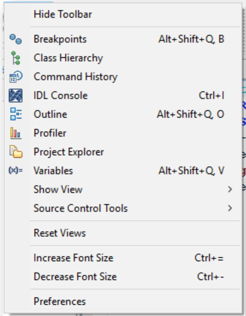
۷ - **Window** : شامل گزینه هایی همچون نمایش و عدم نمایش نوار ابزار، پنجره های محیط IDL، برگданدن به حالت پیش فرض مرتب سازی پنجره ها، افزایش و یا کاهش فونت نمایش خطوط متن از کدهای نوشته شده و همچنین تنظیمات کلی محیط IDL می باشد.
