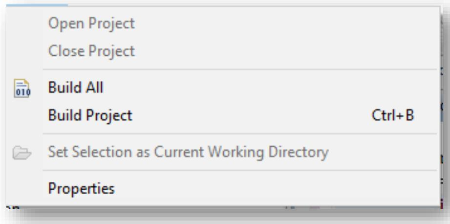
۱۴- **Project :** شامل گزینه هایی برای باز و یا بسته نمودن یک پروژه، ساخت یک پروژه منبع بسته و غیرقابل ویرایش بشکل .sav. از یک پروژه، تعیین محل پروژه بعنوان پوشش جاری IDL و نهایتاً انجام تنظیمات کلی پروژه می باشد.
